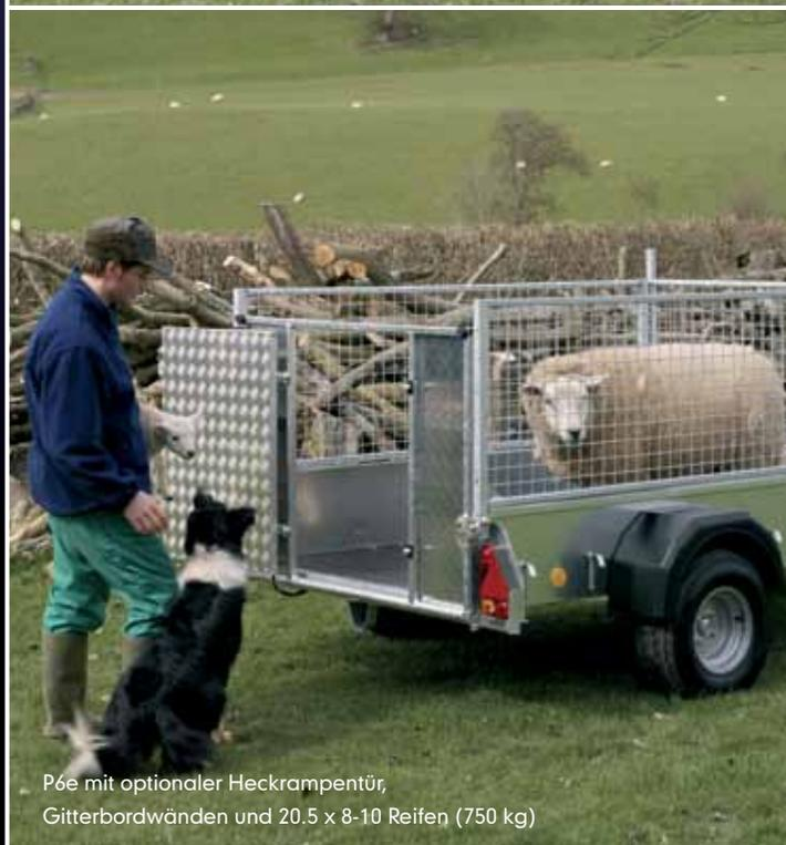
P6e mit optionaler Heckrampentür, Gitterbordwänden und 20.5 x 8-10 Reifen (750 kg)
