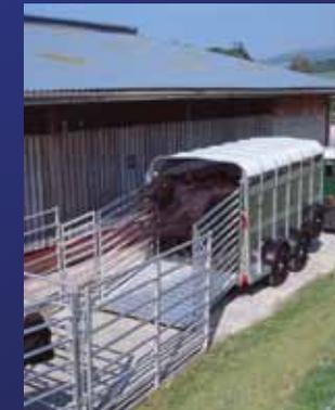
Der TA5 1,83m ist in den Längen von 2,44 m, 3,00 m, 3,66 m und neu in 4,27 m erhältlich. Das 2,13m-Modell ist in den Längen 3,00 m, 3,66 m und neu in 4,27 m erhältlich. Die 2,44 m und 3,05 m Ausführungen haben ein maximal zulässiges Gesamtgewicht von 2.700 kg, wohingegen die 3,66 m und 4,27 m Modelle ein max. zulässiges Gesamtgewicht von 3.500 kg bieten.
