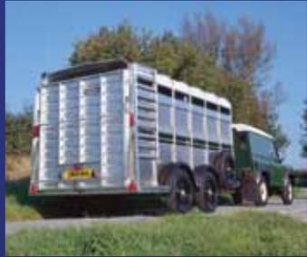
TA510 3-Achser 4,27m Gesamtlänge (1,83m Kopfhöhe) optional mit unterer Belüftungsschiene
