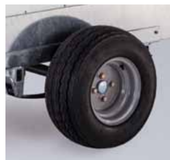
Q5/6/7e Gelände-Anhänger Flotation-Reifen (20,5 x 8-10)
