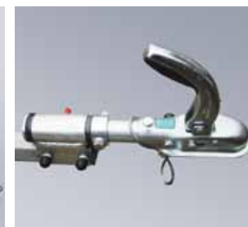
Optionale Drehkupplung erhältlich für das Geländemodell (nicht zugelassen für Strassenbenutzung*)
