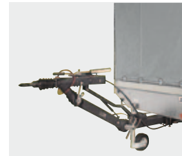
1 Höhenverstellbare Deichsel & Din-Zugöse (Option)
